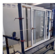
Foto nº. 05 Ensaio de resistência ao esforço horizontal com dois cantos imobilizados
