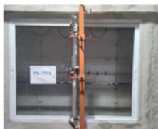
Foto nº. 03 Verificação do Comportamento quando submetida a cargas uniformemente distribuídas. Posicionamento dos defleômetros.
