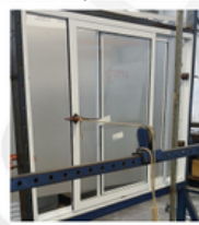
Foto nº. 06 Ensaio de resistência à flexão, do lado externo para o interno
